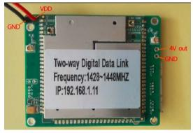
电源信号见上图,电源输入为2个焊孔,支持7~25V宽电压输入。
