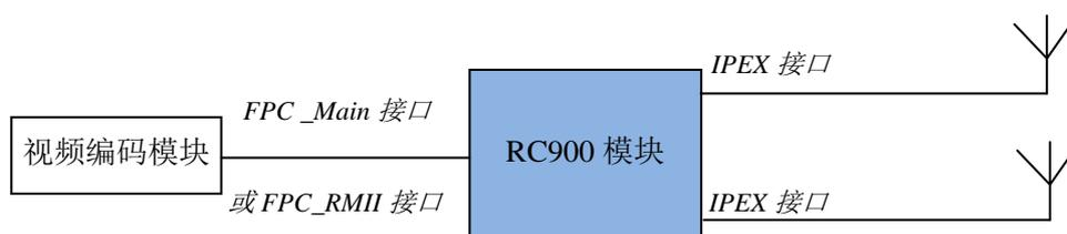
采用 Sihid RC900 模块组建 COFDM 数字高清无线图传发射系统(单 PA 单天线)示意图:
