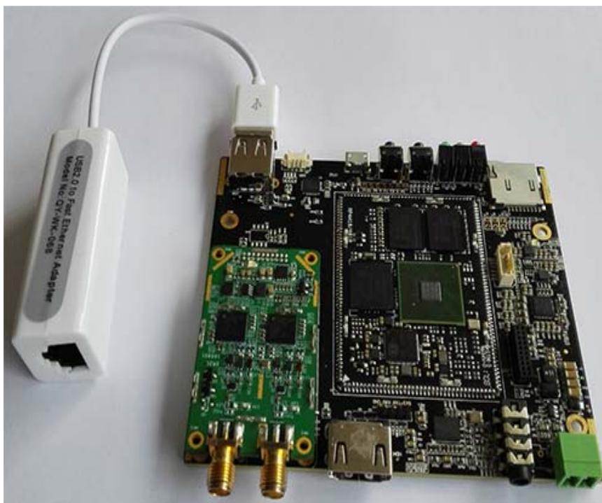
6) SHD3 板的 USB Host 接口外接 USB 网口适配器，通过网口输入 H264 视频流进行低延时解码播放。针对此类应用，必须更换 SHD3 固件，烧写特殊版本软件，有需要的客户请联系矽海达公司。
