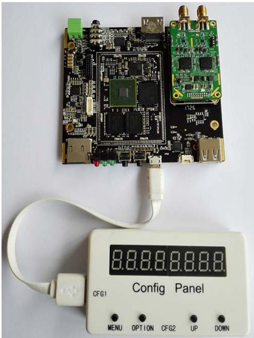
4) SHD3 板的 USB Host 接口可外接智能手机或平板, 将视频流传输到手机或平板上播放显示。矽海达提供 Android APP 软件 Splayer 运行于智能手机或平板上进行视频播放显示。矽海达 SHD3 通过 DR2C 或 DR900 接收 COFDM 无线视频, 可同时输出到 HDMI 显示器、AV 显示器及智能手机或平板上进行视频播放。
