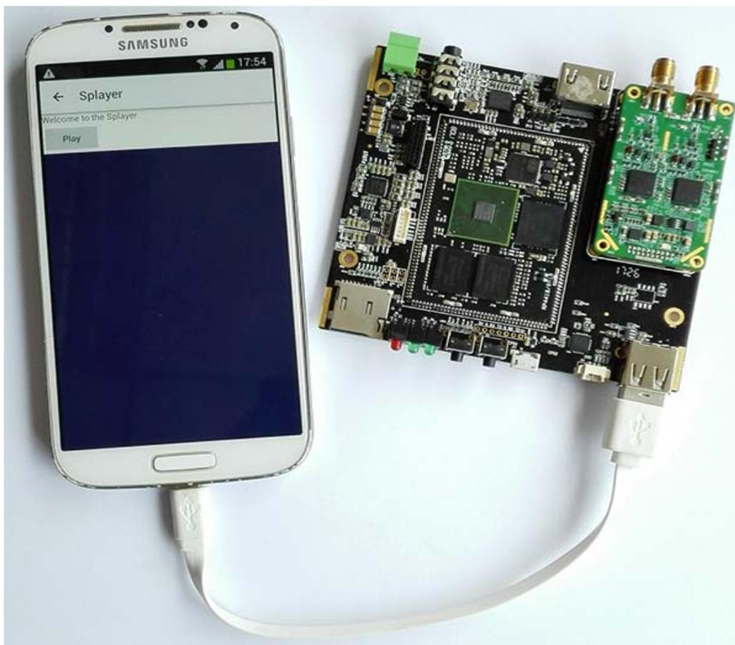
5) SHD3 板的 USB Host 接口可外接 USB 网口适配器，将 DR2C 或 DR900 接收到的 COFDM 无线视频流通过 USB 网口适配器传输到 PC 网口或者 NVR 设备，进行解码播放。针对此类应用，必须更换 SHD3 固件，烧写特殊版本软件，有需要的客户请联系矽海达公司。
