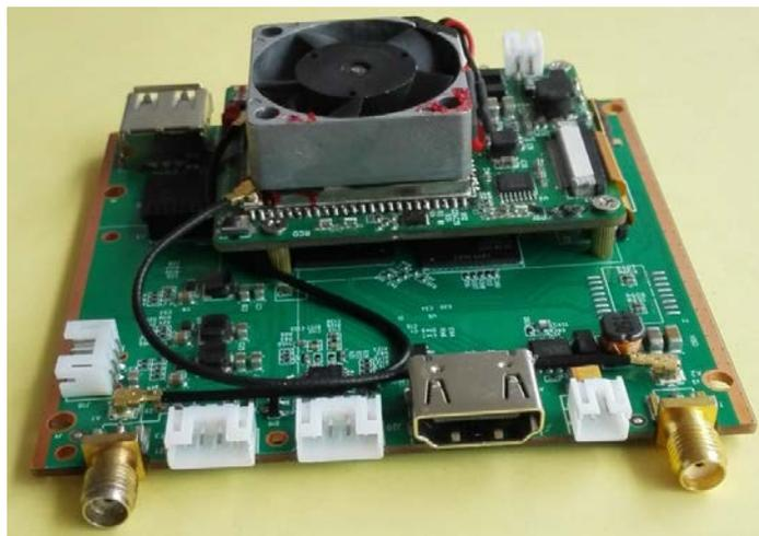
3) SHD5 板的 Config UART 接口可外接串口控制面板，进行运行参数设置，如工作频段、无线带宽、接收密码等的设置。矽海达公司提供 SconA、SconB、SconC 等型号配参面板供客户选择，详见配参面板介绍文档。
