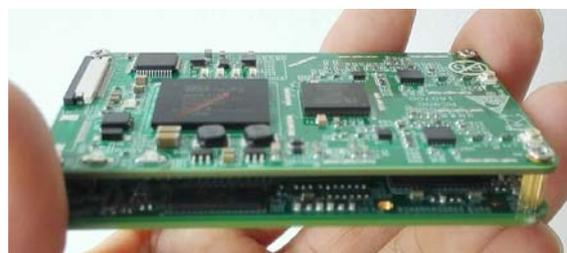
SUE1 板还可与 [RC-Hat](#) 堆叠组合在一起，对外直接提供 RJ45 接口，连接接口也是 FPC Connector(26PIN flat cable 软排线接口)。这时，视频通过 HDMI 或 AV 接口输入，经 H.264 编码压缩后通过 RJ45 网口输出。
