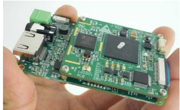
2) SUE2 可与 SUE-Hat1 扩展板堆叠在一起，通过 FPC 接口软排线连接，对外提供 RS232 参数配置串口(CFG)、RS232 透明数据传输串口(Data)、4PIN 以太网口。
