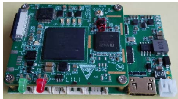
SUE5 编码板对接矽海达 RCB COFDM 调制模块
