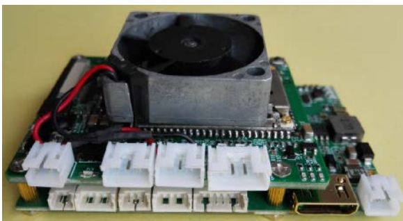
SUE5 编码板对接矽海达 RCD 双向无线传输模块
