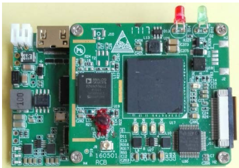
SUE5 编码板对接矽海达 RCB COFDM 调制模块
