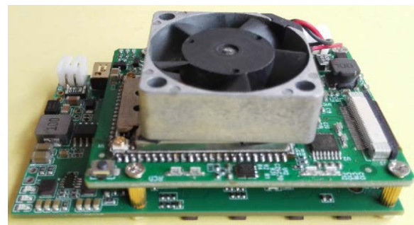
SUE5 编码板对接矽海达 RCD 双向无线传输模块
