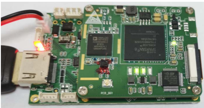
SUE6 编码板对接矽海达 RCB COFDM 调制模块
