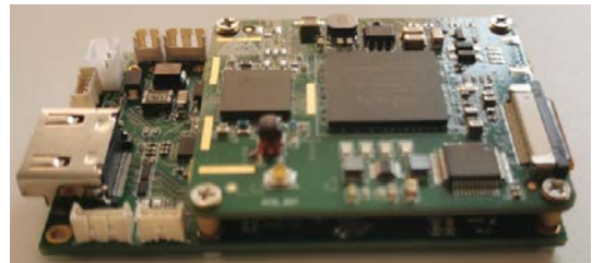
SUE6 编码板对接矽海达 RCB COFDM 调制模块
