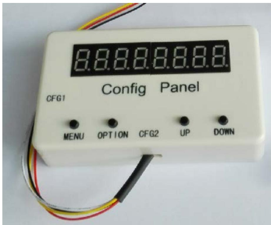
SconB 配参面板采用 8 个 8 段数码管显示，有 4 个操作按键，与图传模块(发射模块、接收模块、编码板、解码板、中继模块、透传模块等)的连接方式可根据应用需要及不同的图传模块采用以下 2 种方式之一：
