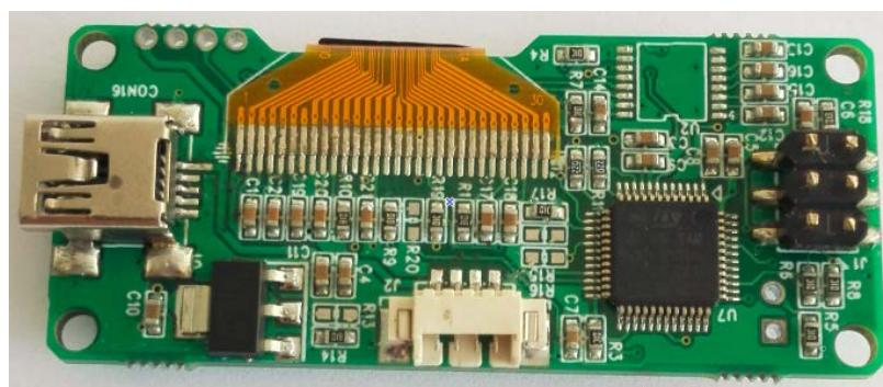
SconA 配参面板采用 0.96 英寸 OLED 显示屏，有 3 个操作按键，与图传模块(发射模块、接收模块、编码板、解码板、中继模块、透传模块等)的连接方式可根据应用需要及不同的图传模块采用以下 3 种方式之一：
